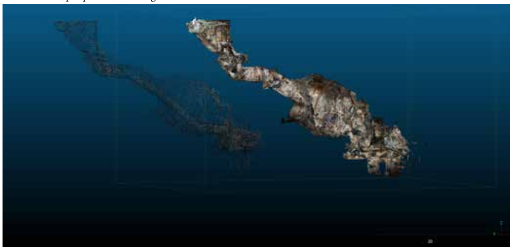
Torri di Slivia , sezione ingresso oggetto del corso, prospetto da scansione LiDAR con GeoSlam e LiDAR iPhone
