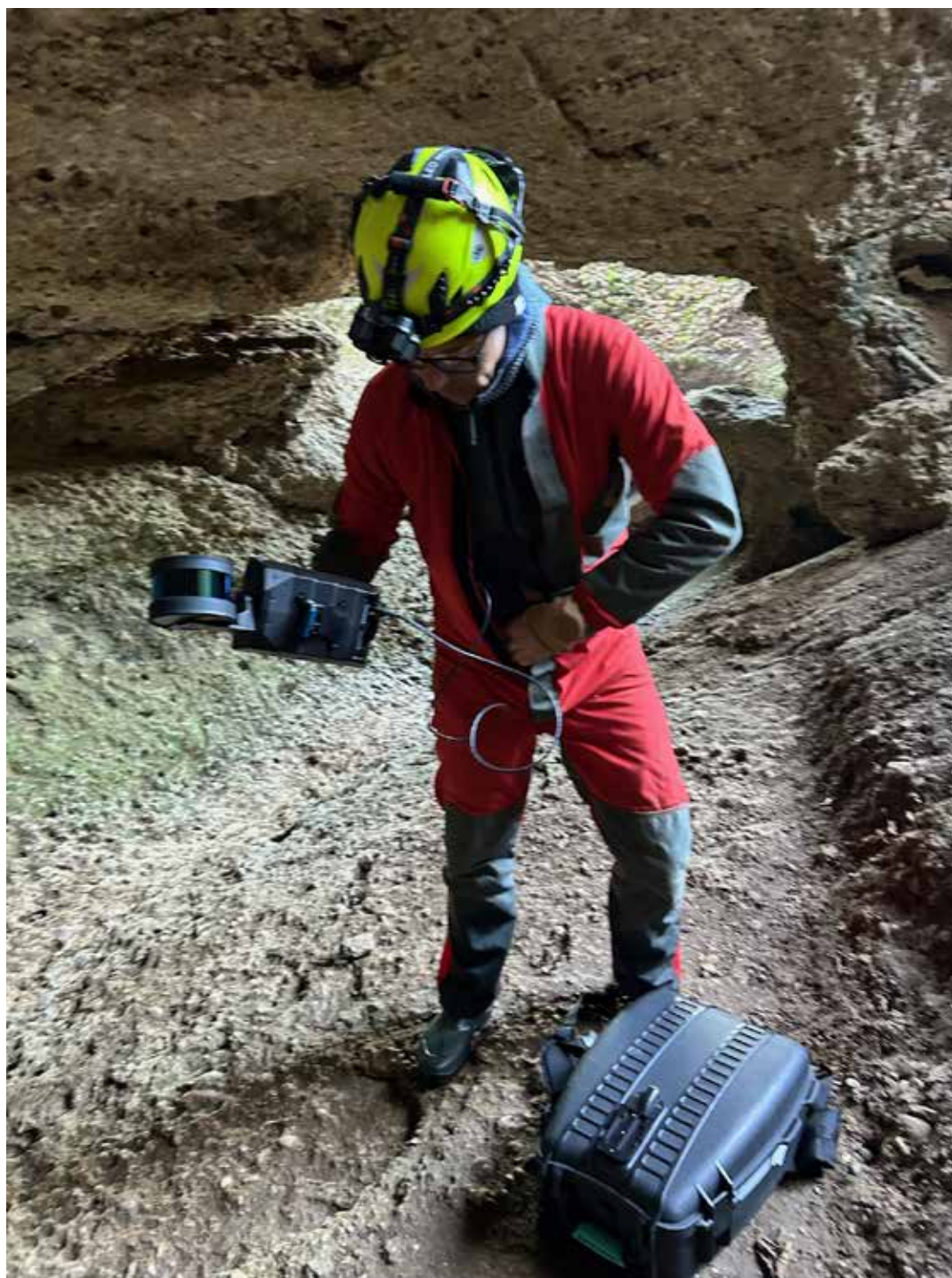
L'Ing. Paolo Corradeghini predispone lo strumento a tecnologia SLAM per effettuare una scansione ad alta densità di punti della parte iniziale del Tavarán Grando, foto M. Battajon
