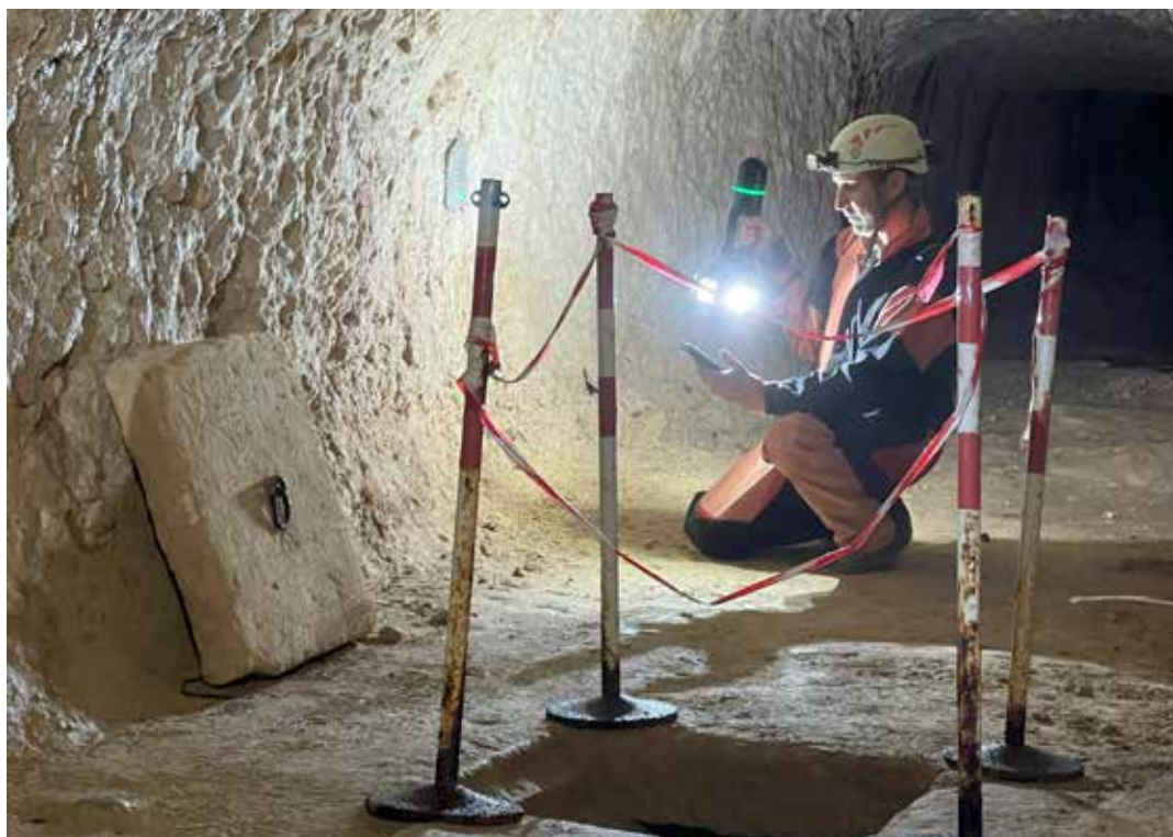
Asolo, Acquedotto La Bot, Scansione condotta superiore con Leica BLK2GO, foto Massimiliano Zago
