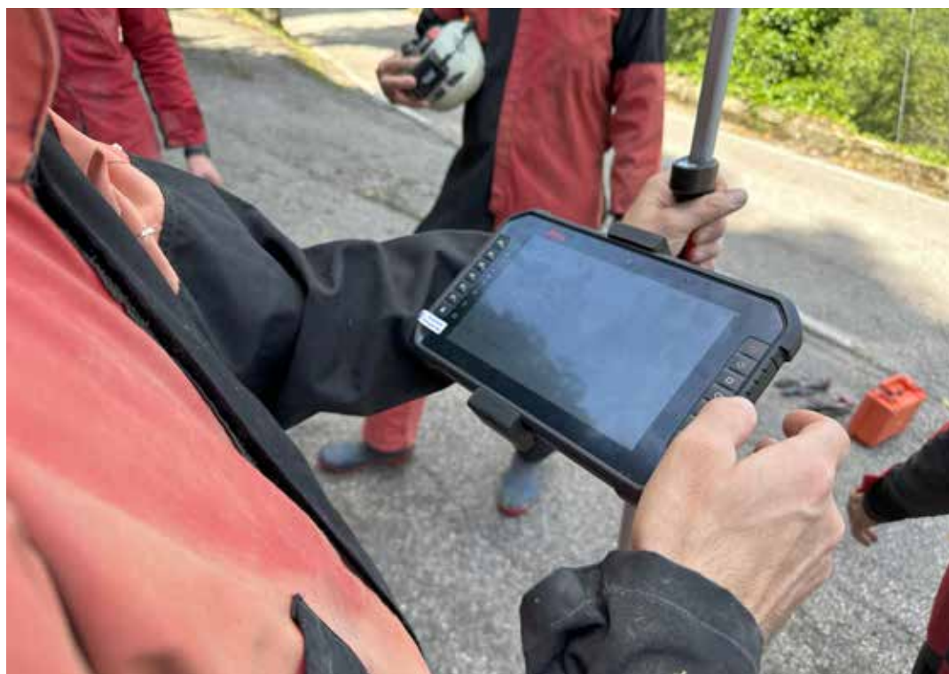
Asoło, Acquedotto La Bot, Georeferenziazione caposaldo per inizio scansione, foto Massimiliano Zago
