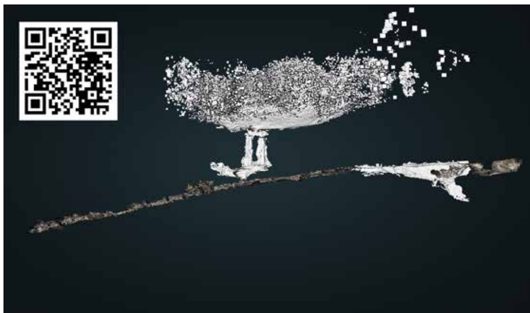
Modello tridimensionale Bo de Pavei, si notano le aree incolori realizzate con GeoSlam e le colorate con iPhone , Marcello Pellegrini In alto a sinistra QR-Code modello tridimensionale Potree del Bo de Pavei
