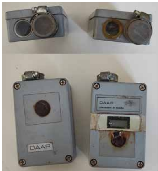
Distanziometri, fonte Mauro Villani, dal magazzino del Gruppo Ricerche Speleologiche E.A. Martel di Carbonia. Realizzati da Armando Davoli di Reggio Emilia
