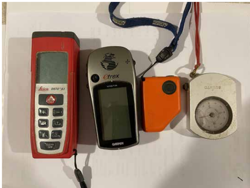
Strumenti di rilievo in dotazione al GNM, da sx: Misuratore Leica Disto A3, GPS Garmin etrex, Clinometro, Bussola Suunto
