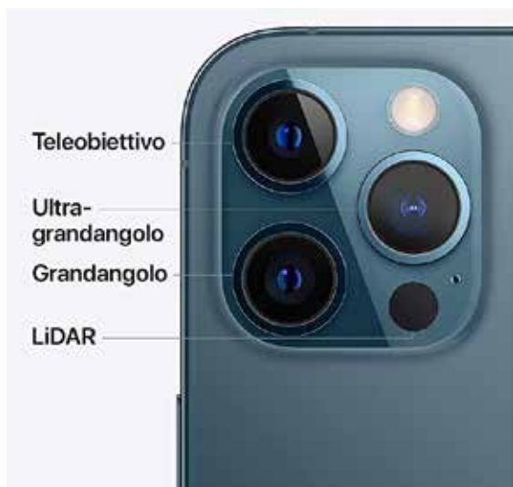
iPhone 12 pro max, parte posteriore con in evidenza le 3 fotocamere, il led di illuminazione e il sensore LiDAR
